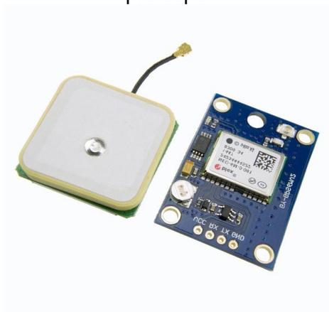
Figura 11. Modulo GPS NEO-6M
