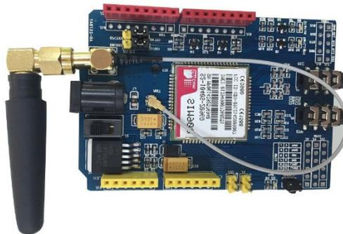
Figura 13. Módulo Gsm SIM900
